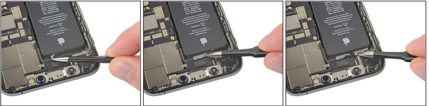
⚠ Die oberen Zuglaschen befinden sich sehr nahe der [Face ID Sensoren](#). Wenn diese beschädigt werden, kann Face-ID nur von Apple wieder hergestellt werden. Arbeite also sehr behutsam und berühre die Linsen nicht mit den Fingern.
