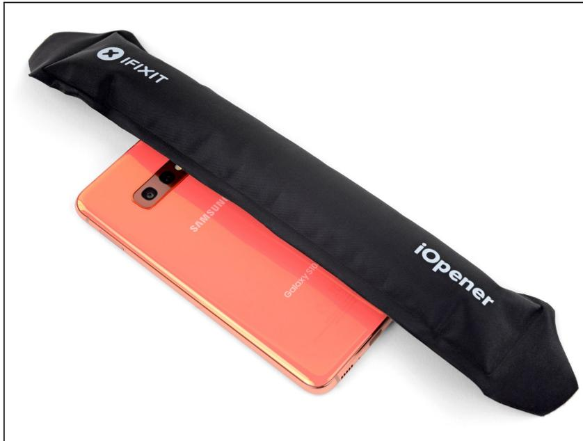
**i** Beim Öffnen deines Smartphones wird die wasserdichte Versiegelung beschädigt. Achte darauf, Ersatzklebestreifen zur Hand zu haben, bevor du weitermachst, oder vermeide es, dein Smartphone Flüssigkeiten auszusetzen, falls du es zusammenbaust, ohne die Klebestreifen zu ersetzen.
