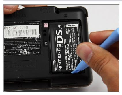
Heble den Akku mit einem Plastiköffnungswekzeug oder einem Spudger heraus. Wenn du kein solches Werkzeug hast geht es vielleicht mit dem Fingernagel.
