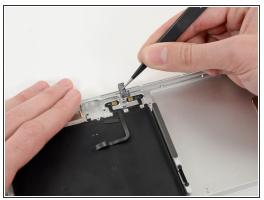
Wiederhole diesen Schritt für das Stück Klebeband auf dem zweiten Mikrofon und entferne es.
