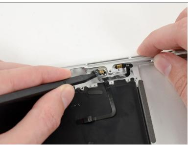
Heble vorsichtig das erste Mikrofon aus dem oberen Gehäuse.
