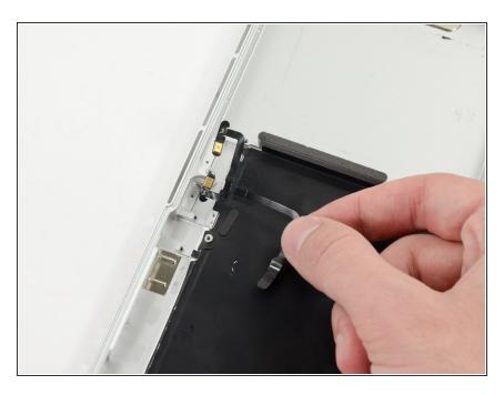
Hebe die Mikrofoneinheit hoch und entferne sie aus dem oberen Gehäuse.
