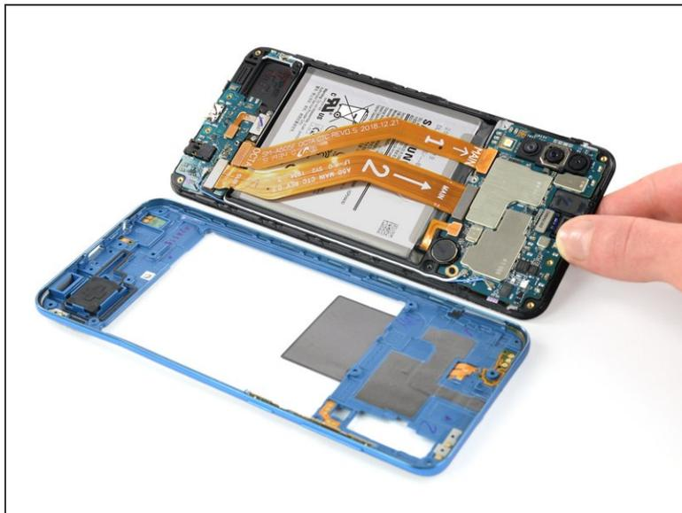
**i** Vergewissere dich, dass alle Rasten des Mittelrahmens gelöst sind.
