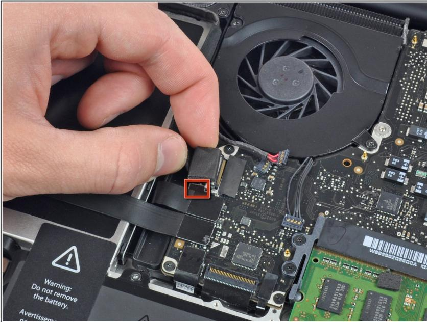
**⚠** Du musst den kleinen durchsichtigen Kunststoffkabelhalter (rot markiert), der am Logic Board festgeklebt ist, aus dem Weg schieben, bevor du das Kamerakabel abtrennen kannst. Achte darauf, dass du keine Bauteile von der Platine brichst, während du es vom Kamerakabelstecker abschiebst.
