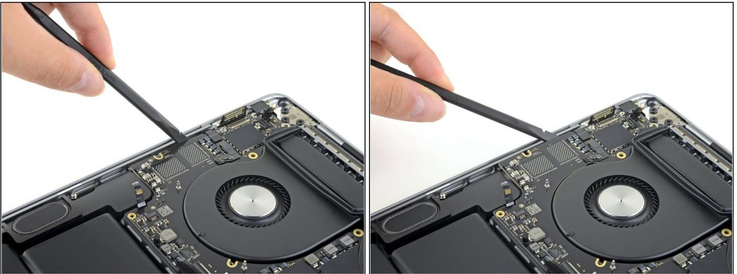
**i** Die Logic Board-Einheit sitzt sehr eng, aber du kannst dir den Ausbau etwas erleichtern, indem du einen Spudger unter die linke Kante schiebst und sie ganz **leicht** nach oben hebst.
