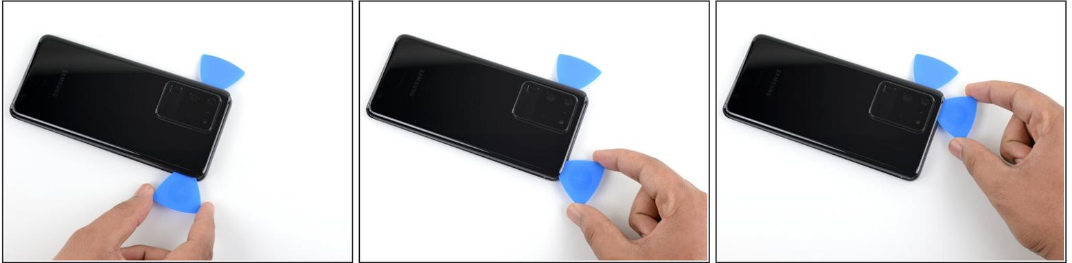
**⚠** In der Nähe der Ecken ist das Glas der Rückabdeckung abgerundet und kann leicht brechen. Sei bei diesem Schritt ganz besonders vorsichtig, um zu vermeiden, dass die Rückabdeckung beschädigt wird.
