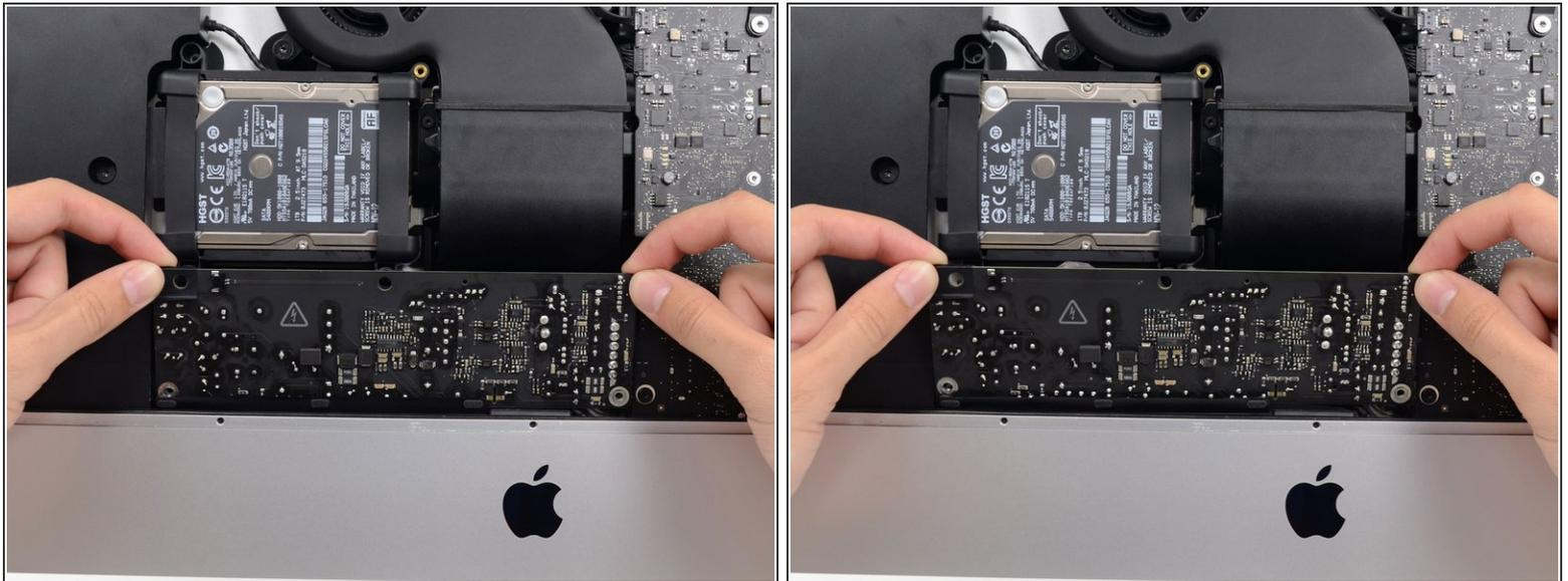
⚠ Wenn du am Netzteil arbeitest, **sei sehr vorsichtig** und berühre nicht die Anschlüsse der Kondensatoren oder offene Lötstellen auf der Rückseite des Netzteils. Fasse die Platine nur an den Kanten an.
