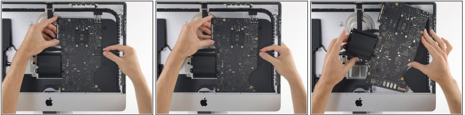
**⚠** Achte beim Ein- und Ausbau des Logic Boards darauf, dass das empfindliche Flachbandkabel zum Mikrophon unten links am Logic Board nicht beschädigt wird.
