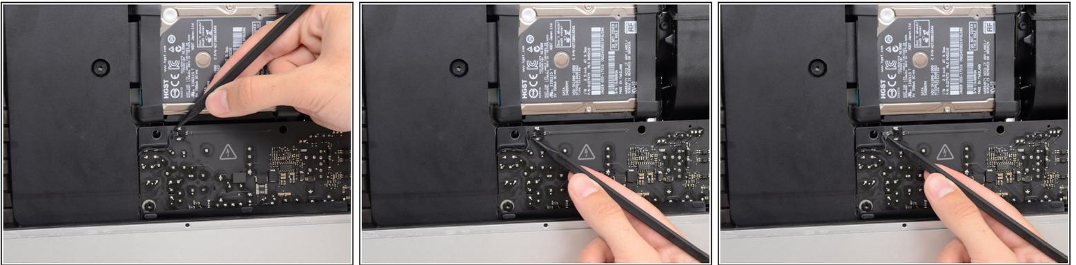
**⚠** Bei den nächsten Schritten musst du mit deinen Händen in der Nähe der offenliegenden Oberfläche der Netzteilplatine arbeiten. Berühre keinesfalls die Oberfläche der Netzplatine oder eine der offenen Lötstellen. Du riskierst bei Berührung einen elektrischen Schlag von den vielen großen Kondensatoren auf der Platine .
