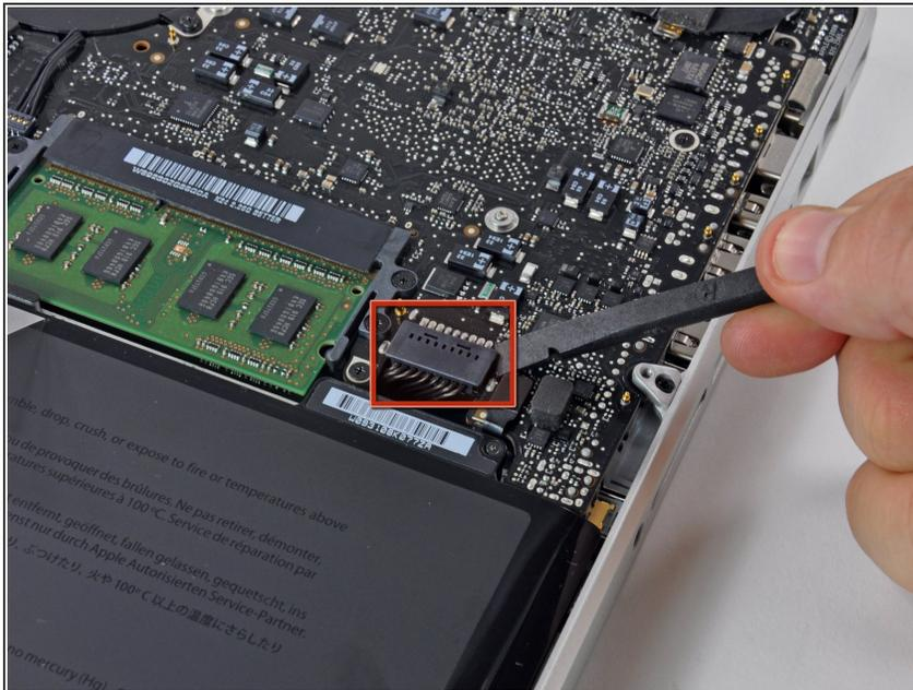
⚠ Wir empfehlen, vorsorglich den Akkuanschluss vom Logic Board zu lösen, um eine elektrische Entladung zu verhindern.
