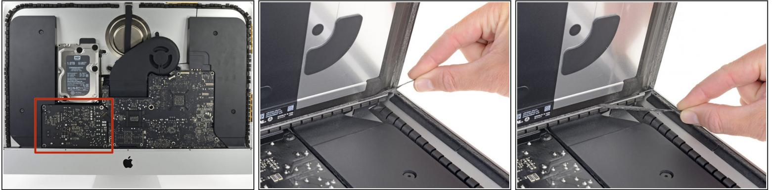
**⚠ Berühre auf keinen Fall die Lötunkte auf der Rückseite des Netzteils und die Zuleitungen der Kondensatoren. (Rote Markierung)**
