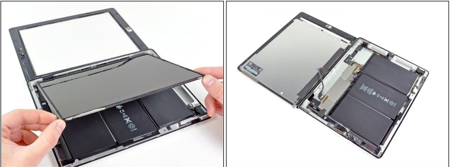
ⓘ Die Front Panel Flachbandkabel sind unterhalb des LCD festgemacht. Um sie zugänglich zu machen, musst du kurzzeitig das LCD aus dem Weg klappen.
