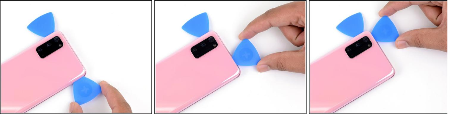
**⚠** In der Nähe der Ecken ist das Glas der Rückabdeckung abgerundet und kann leicht brechen. Sei bei diesem Schritt ganz besonders vorsichtig, um zu vermeiden, dass die Rückabdeckung beschädigt wird.
