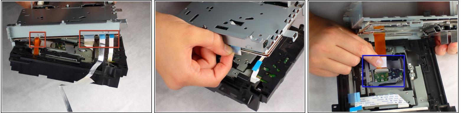
**⚠ Am Laufwerk sind noch vier Flachbandkabel angeschlossen. Sei vorsichtig und beschädige keines davon.**
