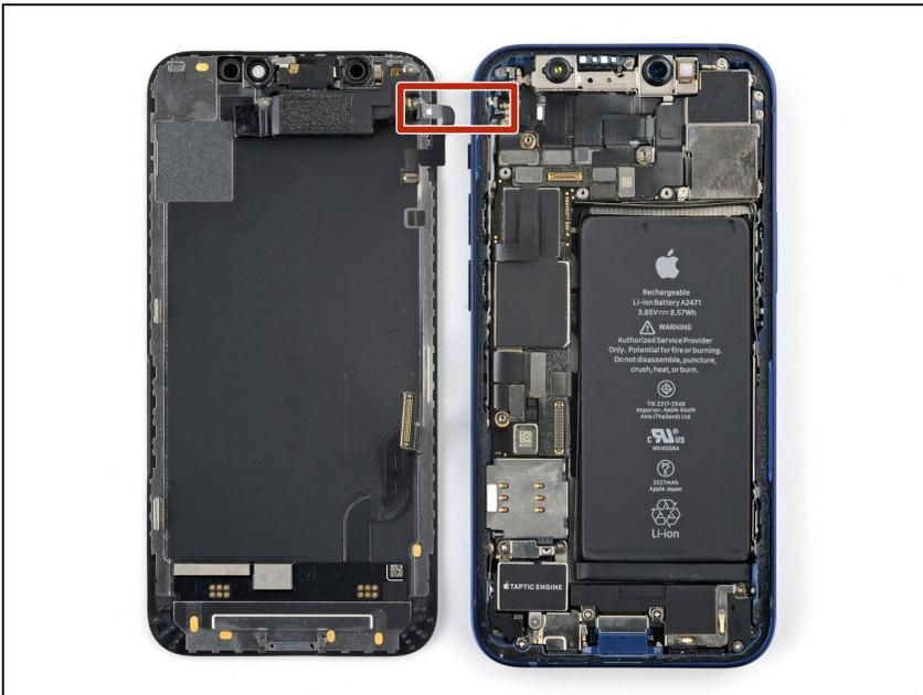
**⚠ An der linken Seitenkante des iPhones verläuft ein empfindliches Kabel. Setze hier kein Plektrum ein, du könntest sonst das Kabel beschädigen.**
