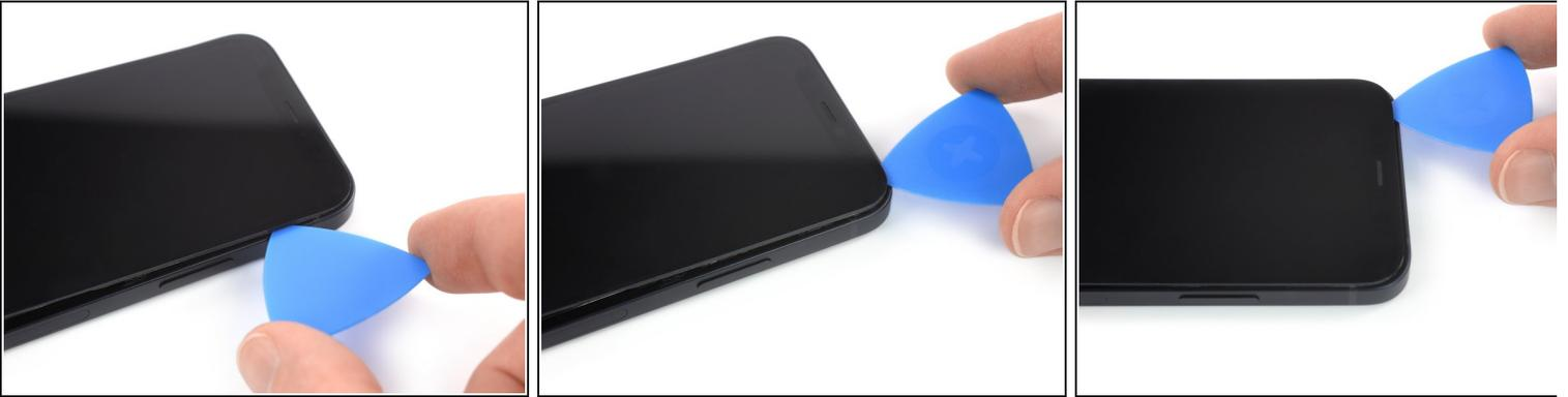
**i** Die Oberkante des Displays ist sowohl verklebt als auch mit Clips befestigt.
