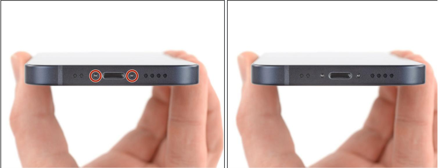
**⚠** Bevor du beginnst, entlade deinen Akku auf unter 25%. Ein geladener Lithium-Ionen-Akku kann sich entzünden und/oder explodieren, wenn er bei der Reparatur versehentlich beschädigt wird.
