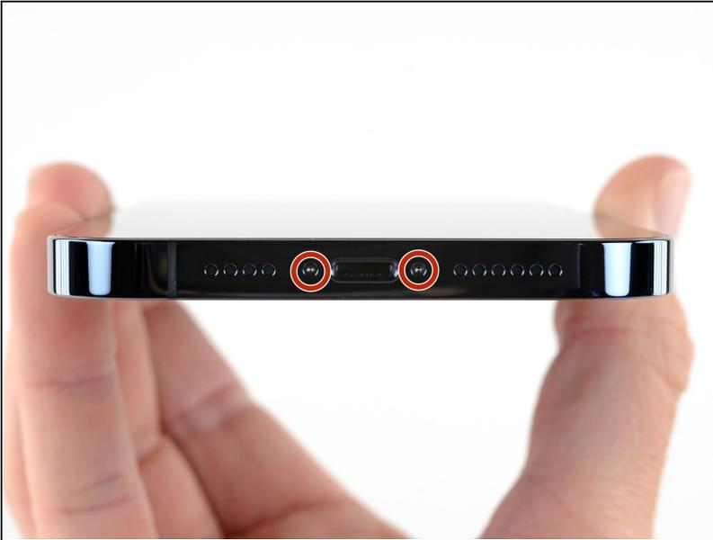
**⚠ Achtung:** Bevor du beginnst, entlade deinen Akku auf unter 25%. Ein geladener Lithium-Ionen-Akku kann sich entzünden und/oder explodieren, wenn er bei der Reparatur versehentlich beschädigt wird.
