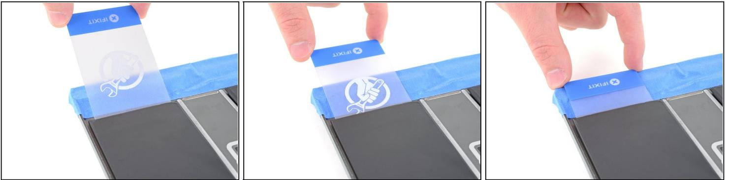
**⚠** Achte beim Hochhebeln des Akkus darauf, ihn mit deinem Werkzeug weder zu durchstechen noch zu verbiegen. Aus einem beschädigten Akku können gefährliche Chemikalien austreten und er kann sich entzünden oder sogar explodieren.
