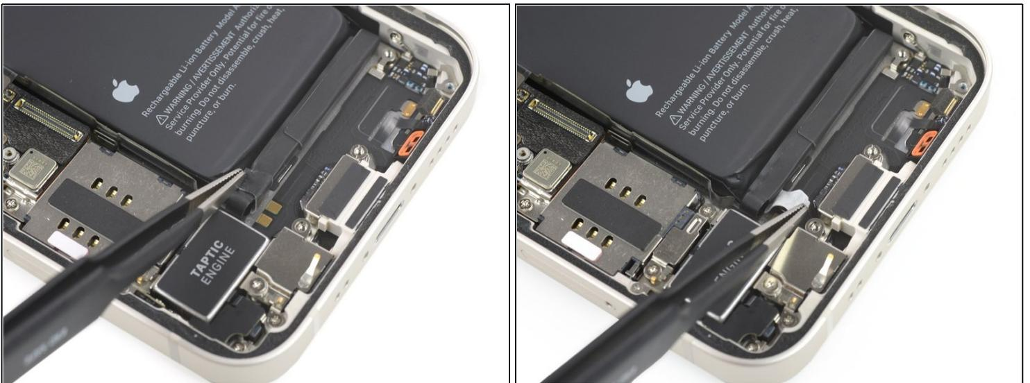
ⓘ Der Akku ist mit drei elastischen Klebestreifen am Rückgehäuse befestigt, zwei an der Unterkante des Akkus, einer an der Oberkante.
