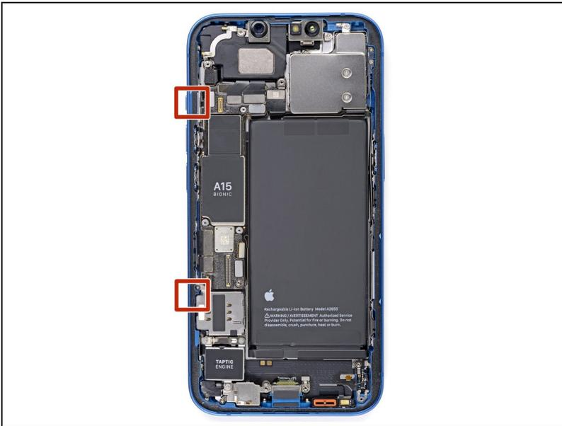
⚠ An der linken Kante deines iPhones befinden sich empfindliche Kabel. **Setze dein Plektrum hier nicht ein**, da sonst die Kabel beschädigt werden könnten.
