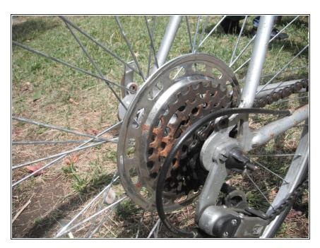
Next, shift the rear derailleur onto the outermost gear.
