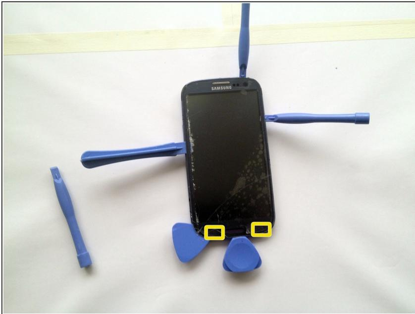
**!** Wenn du beginnst das Glas zu lösen, musst du *von den oberen Ecken aus beginnen und dich zur Mitte hin arbeiten*, um das **gesamte Glas** vom Bildschirm von oben bis unten zu lösen. Lass die Plastiköffner zwischen dem Glas und dem Bildschirm, damit das Glas nicht wieder festklebt.
