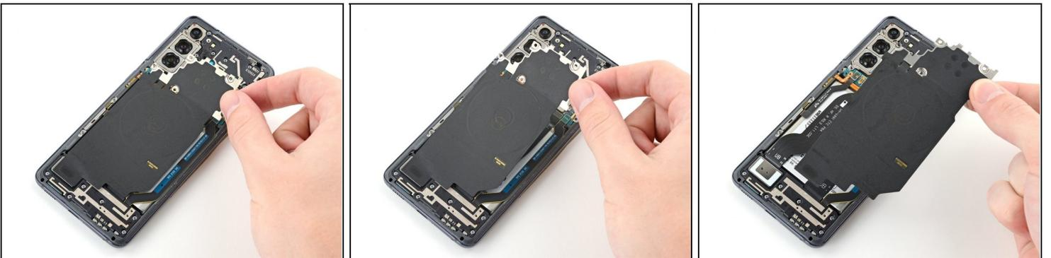
**i** Die Spule zum drahtlosen Laden ist leicht mit dem Smartphone verklebt.
