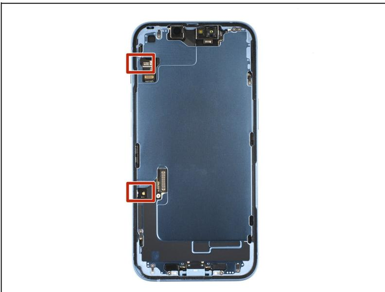
⚠ An der linken Kante deines iPhones befinden sich zwei empfindliche Kabel. **Setze dein Plektrum hier nicht ein**, da sonst die Kabel beschädigt werden könnten.
