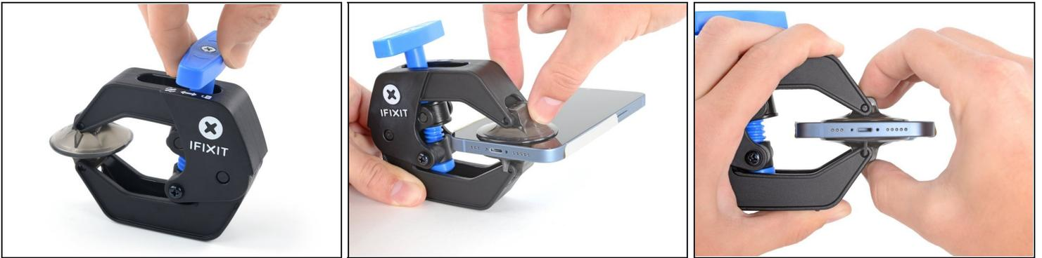
ⓘ In den nächsten drei Schritten wird erklärt wie die Anti-Clamp funktioniert, ein Werkzeug, das wir entwickelt haben, um das Öffnen von Geräten zu erleichtern. **Wenn du die Anti-Clamp nicht verwendest, überspringe die nächsten drei Schritte, danach wird eine alternative Methode erklärt.**
