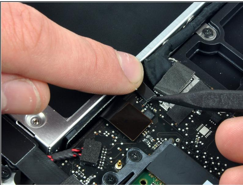
⚠ Apple hat ein kleines Stück durchsichtigen Kunstoffs auf einer Seite des Logic Boards hinter das Kamerakabel geklebt, damit der Stecker im Anschluss drin bleibt. Achte beim Entfernen darauf, dass du keine oberflächenmontierte Bauteile auf dem Logic Board beschädigst.
