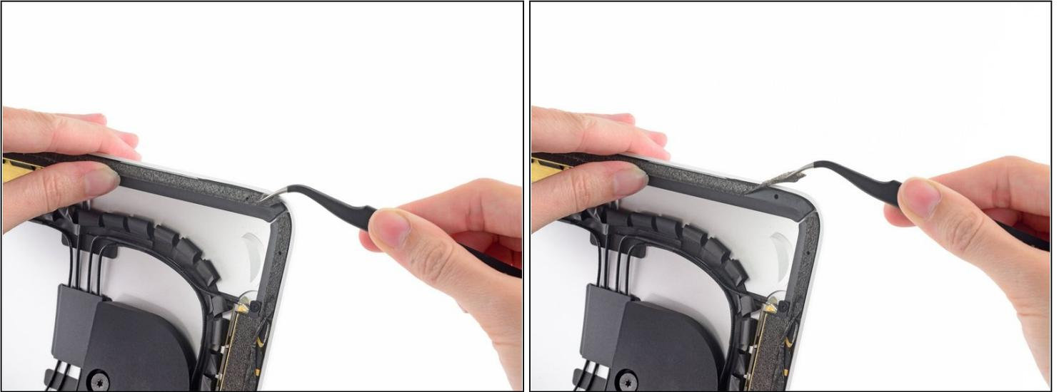
**⚠** Bevor du die Klebestreifen anbringst, musst du erst die Reste der alten Streifen vom Rand des hinteren Gehäuses entfernen.
