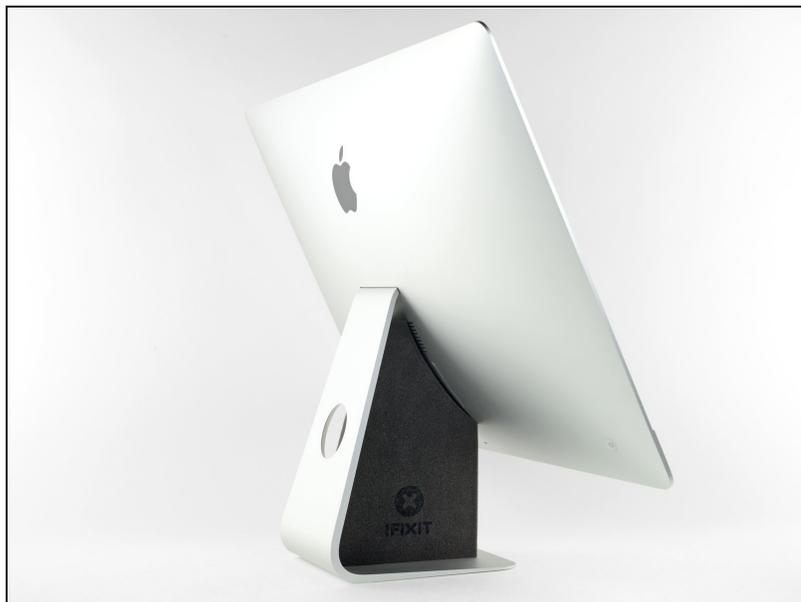
① ヒンジを自由に動かせる状態だと、iMacが不安定なため作業が難しくなります。図のように修理を完了することはできますが、iMacサービスウェッジを使用すれば、より迅速かつ簡単に修復できます。
