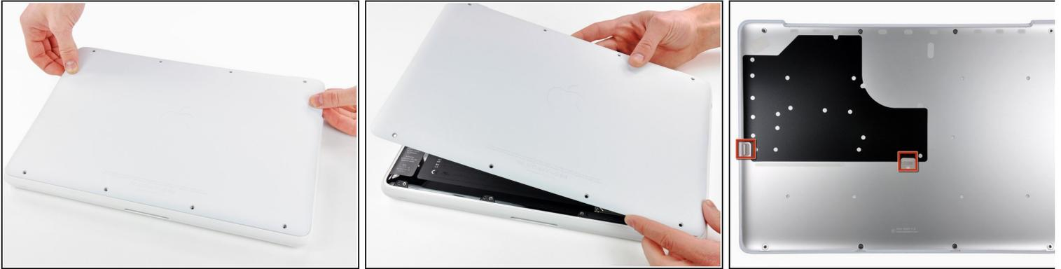
**⚠** Die untere Abdeckung besteht aus gummibeschichtetem Aluminium. Vermeide starkes Verbiegen der Abdeckung, da jede dauerhafte Verformung dazu führt, dass die Abdeckung nicht mehr exakt auf das Gehäuse passt.
