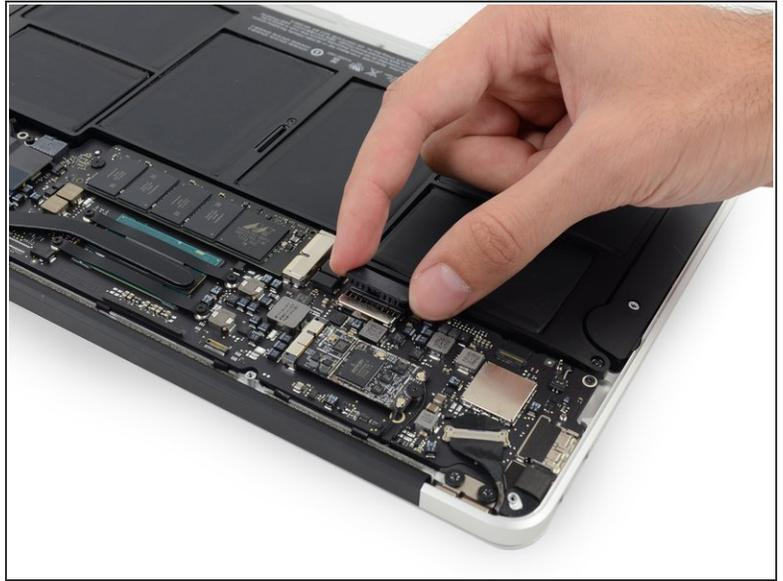
**⚠ In diesem Schritt wirst du den Akku abtrennen, damit es während der Reparatur keinen Kurzschluss gibt.**
