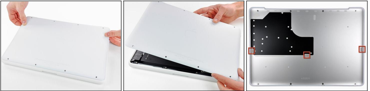
**⚠** Die untere Abdeckung besteht aus gummibeschichtetem Aluminium. Vermeide starkes Verbiegen der Abdeckung, da jede dauerhafte Verformung dazu führt, dass die Abdeckung nicht mehr exakt auf das Gehäuse passt.
