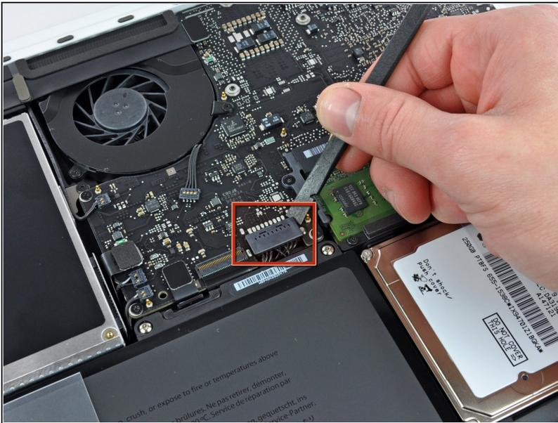
⚠️ Aus Gründen der Vorsicht empfehlen wir, den Akkuanschluss vom Logic Board zu lösen, um eine jegliche elektrische Entladungen zu vermeiden. Dieser Schritt ist **optional** und nicht zwingend notwendig.
