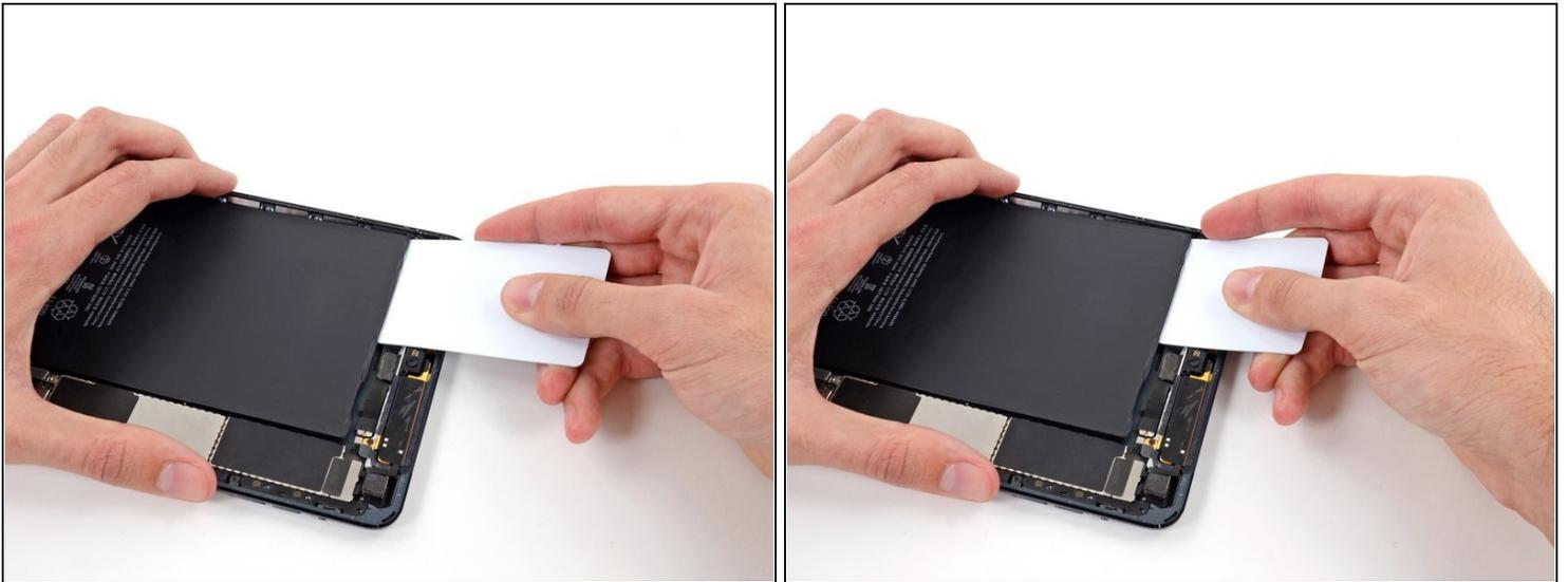
**⚠** Im Folgenden wirst du dünne Plastikkarten zwischen den Akku und das Rückgehäuse des iPads schieben, um den Kleber, mit dem der Akku befestigt ist, zu durchtrennen. Achte darauf, die Karten so flach wie möglich zu halten, um ein Verbiegen des Akkus zu vermeiden, und somit eventuelle Beschädigungen und das Austreten gefährlicher Chemikalien.
