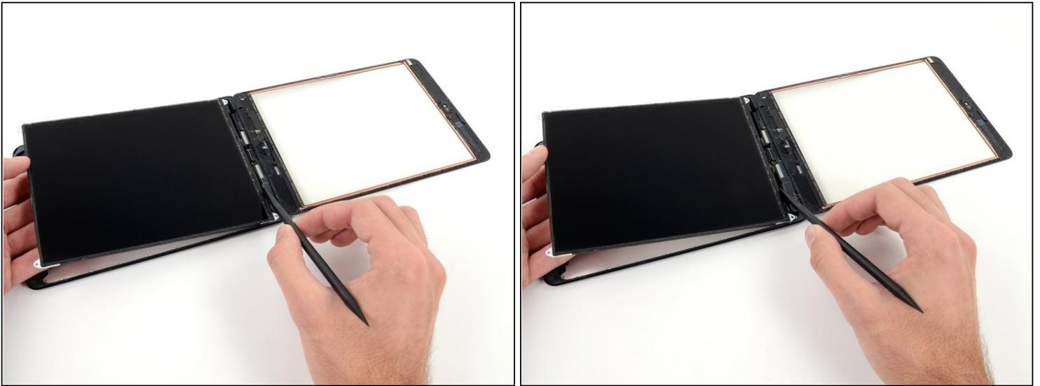
ⓘ Zwei breite Klebestreifen verbinden das LCD mit den Lautsprechern.
