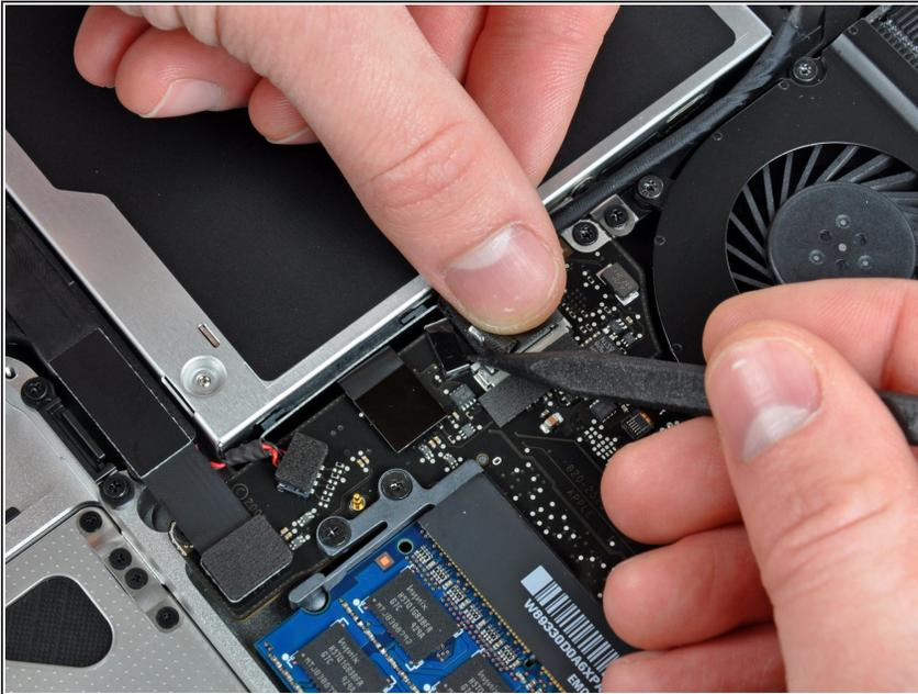
**⚠** Apple klebt ein kleines Stück durchsichtigen Kunstoffs auf eine Seite des Logic Boards hinter den Stecker des Kamerakabels, um ihn im Anschluss zu befestigen. Wenn du es entfernst, dann achte darauf, dass du keine der oberflächlich befestigten Bauteile auf dem Logic Board beschädigst.
