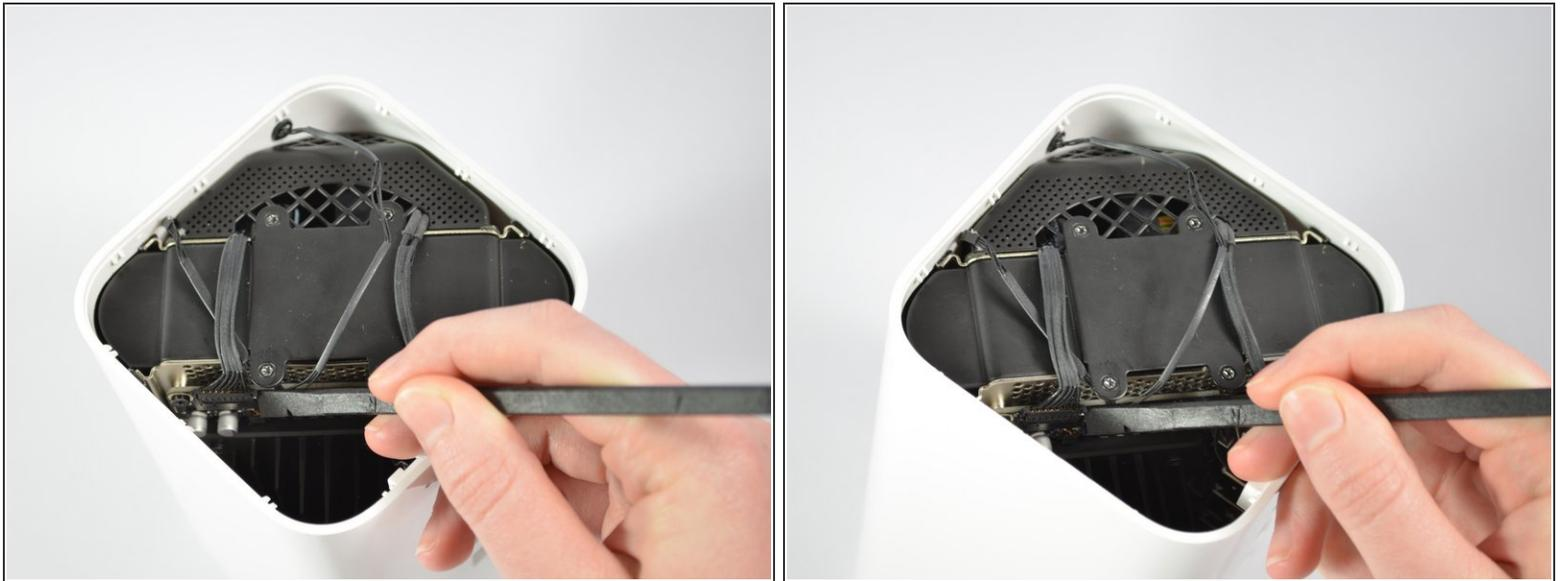
**!** Vier schwarze Kabel, ein dickes und drei dünne, führen zum Logic Board: eines hat einen breiteren Anschluss, die anderen schmalere. Behandle die Anschlüsse gut, sie sind sehr empfindlich.
