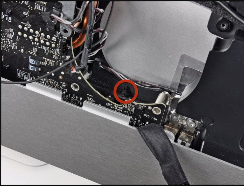
⚠ In den folgenden Schritten wirst du das Logic Board aus dem äußeren Gehäuse herausholen. Denke dabei an die vielen Kabel, mit denen es immer noch mit dem äußeren Gehäuse verbunden ist.
