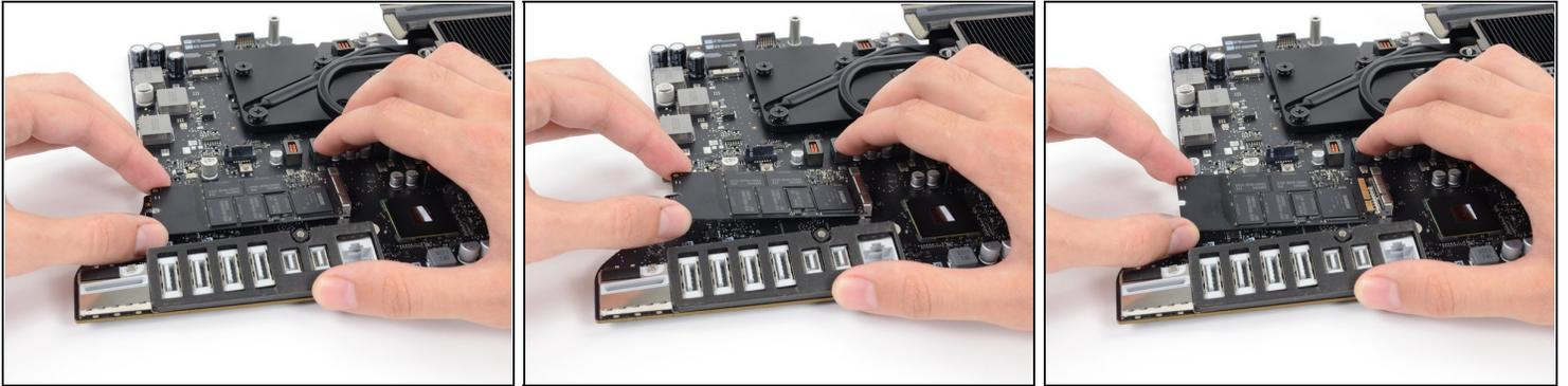
**⚠** Der Anschluss der SSD darf nicht beschädigt werden, hebe das Ende der SSD deswegen nicht mehr als etwa 15° an.
