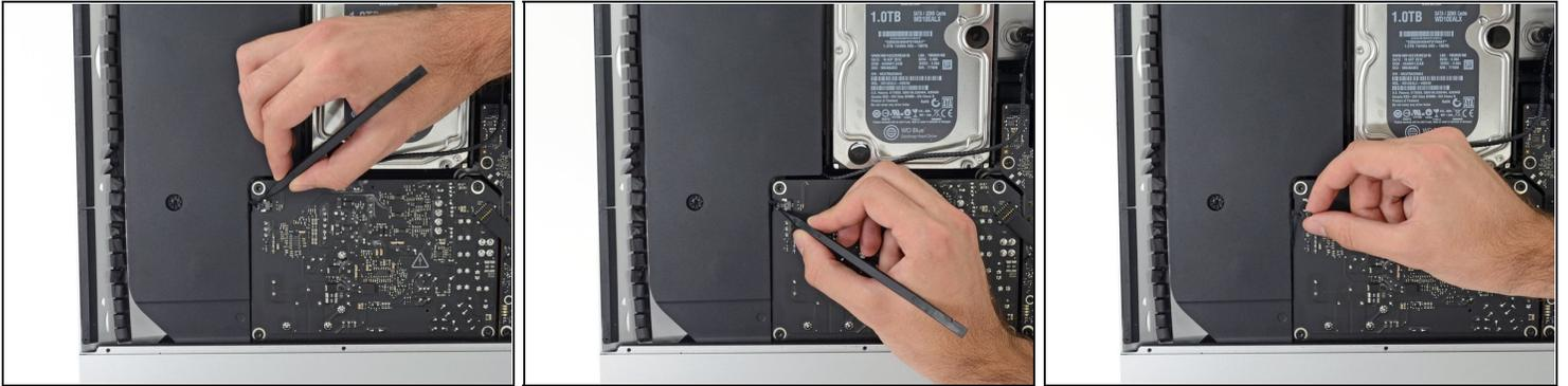
⚠ Achte darauf, keine Lötverbindungen auf der Rückseite der Stromversorgung zu berühren. Kondensatoren können genug aufgeladen sein, um dir einen gefährlichen Schock zu verpassen.
