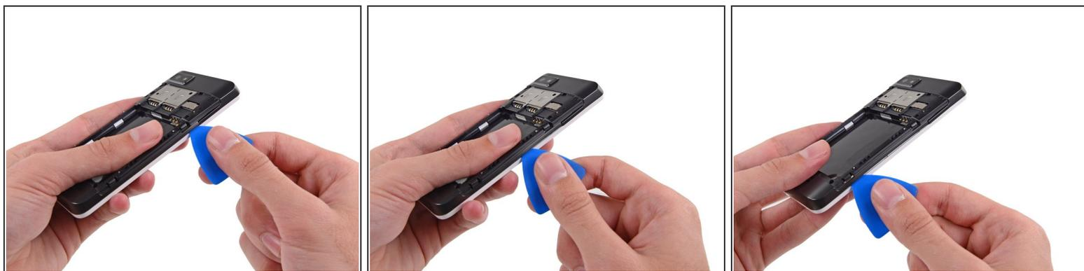
**i** Der Mittelrahmen ist mit mehreren kleinen Plastikclips an der Displayeinheit festgemacht.
