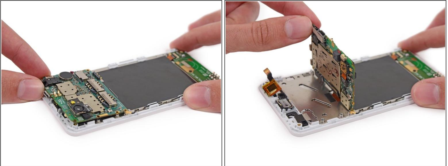
**⚠** Versuche **nicht** das Motherboard jetzt schon zu entfernen, da es immer noch an der Displayeinheit durch das Display Datenkabel festgemacht ist.
