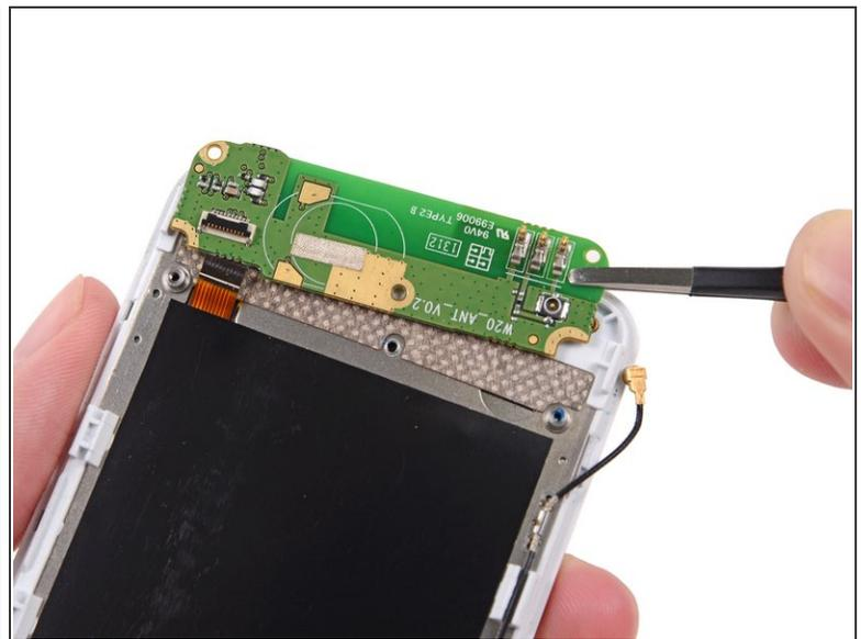
**i** Das Wi-Fi Antennen Daughterboard ist am Front Assembly mit einem leichten Kleber angebracht.
