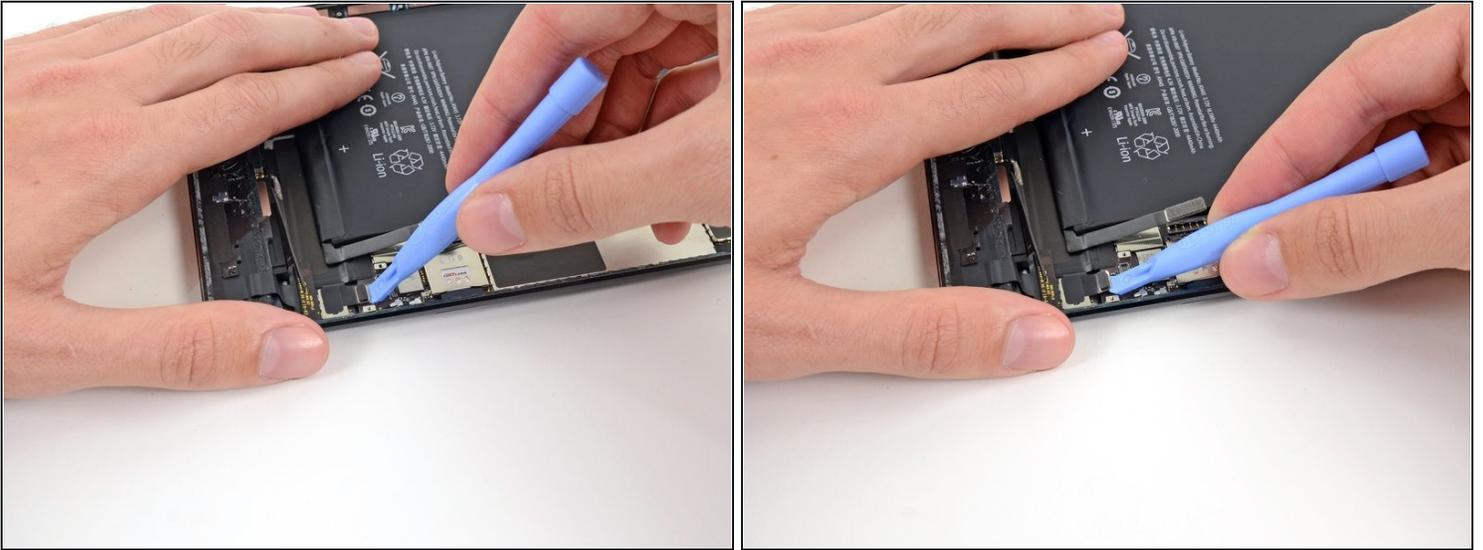
**⚠ Achte darauf, dass du gleichmäßig am Anschluss des digitalen Touchscreens hebelst und keinesfalls am Anschluss selbst. Der Anschluss und der Stecker sind sehr empfindlich, und wenn du einen von beiden beschädigst, wird dein Touchscreen nicht funktionieren.**
