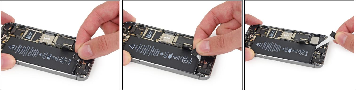
**⚠** Versuche den Streifen während dieser Prozedur, so flach und faltenlos wie möglich zu halten; Gefaltete Streifen können zusammenkleben und dabei beschädigt werden.
