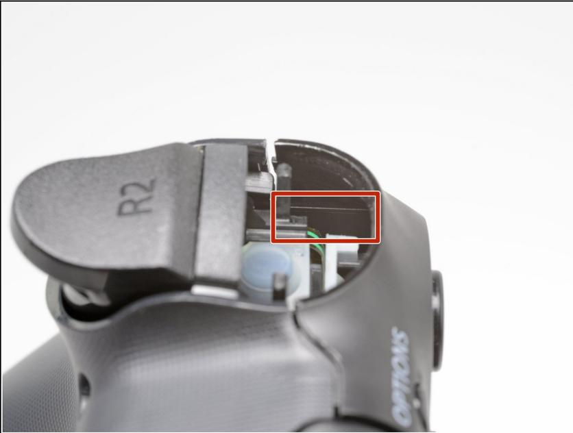
**i** Die letzten beiden Rasten sind sehr empfindlich und müssen von innen aus dem Gehäuse geöffnet werden. Wenn sie dabei brechen, ist es nicht so schlimm, die Reparatur und die Funktion wird dadurch nicht beeinträchtigt.
