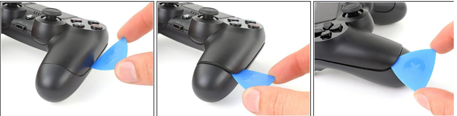
**i** Das Rückgehäuse ist mit sechs Rasten am vorderen Gehäuseteil befestigt. In den nächsten vier Schritten wird gezeigt, wie die Rasten gelöst werden, bevor das Gehäuse geöffnet werden kann.
