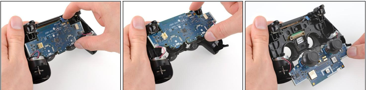
**⚠ Sei vorsichtig und spanne die Kabel zum Vibrationsmotor nicht zu stark an. Falls sie von der Hauptplatine abreißen sollten, löte sie mit Hilfe dieser [Anleitung](#) wieder an.**
