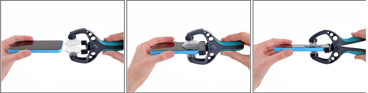
**i** Die nächsten zwei Schritte zeigen, wie man den [iSlack](#) verwendet. Ein großartiges Werkzeug, um das iPhone 5c sicher zu öffnen, das wir jedem empfehlen, der mehr als eine Reparatur durchführen will. **Wenn du den iSlack nicht verwendest, gehe weiter zu [Schritt 5](#).**
