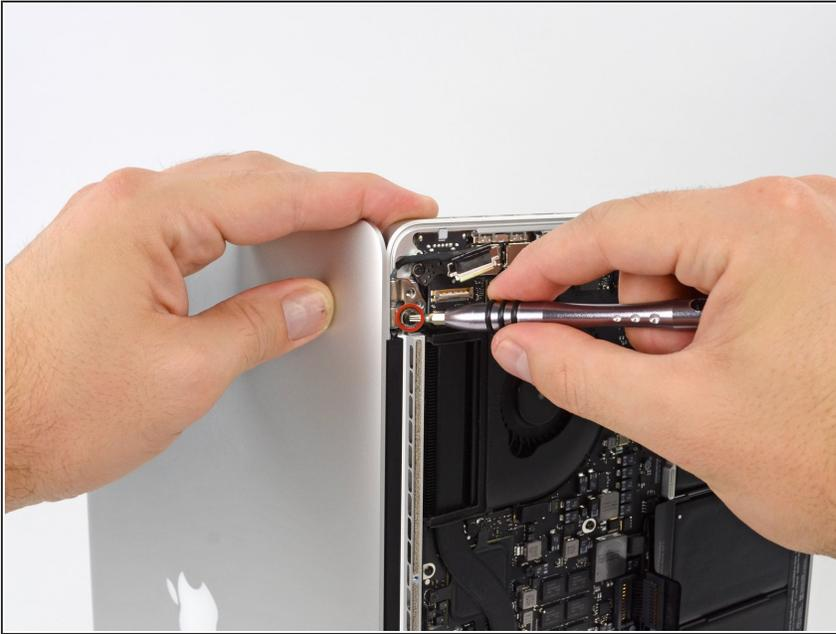
**⚠** Achte darauf, das Display und das obere Gehäuse mit der linken Hand zusammenzuhalten. Andernfalls kann das gerade gelöste Display/das obere Gehäuse umfallen und beschädigt werden.
