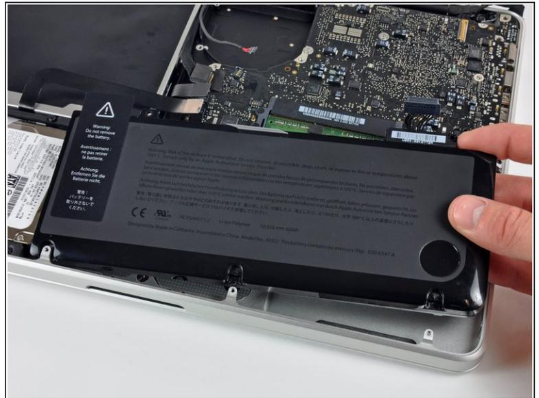
**i** Es ist nicht zwingend nötig den Akku zu entfernen, bevor du das Logic Board heraushebst. Es ist aber sicherer und einfacher. Wenn du den Akku drinnen lässt, achte sehr darauf, dass du das Logic Board nicht am Akku in der Nähe des Strichcodes verbiegst.
