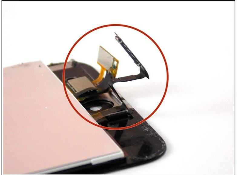
☑ So wird das Flachbandkabel korrekt gefaltet!
