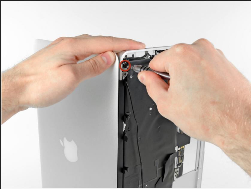
**⚠** Bevor du die letzte Displayschraube entfernst, achte darauf, dass du das Display und den oberen Gehäuseteil mit deiner anderen Hand stabil festhältst. Andernfalls können die Komponenten auf den Tisch fallen und potenziell teuren Schaden verursachen.
