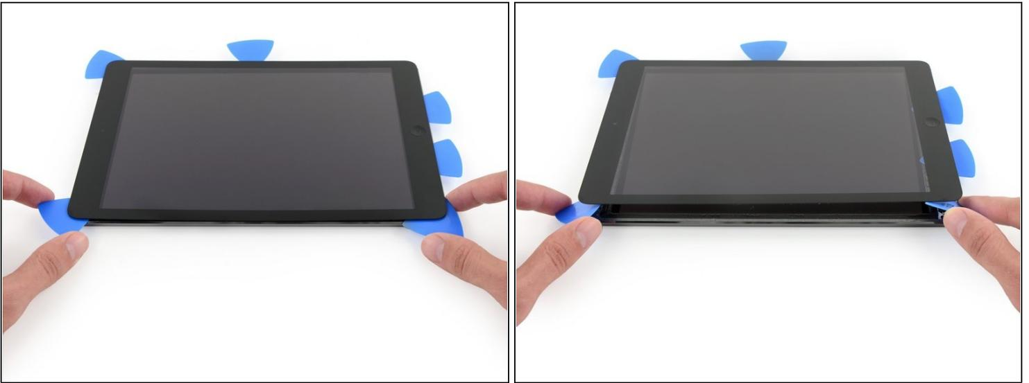
**⚠ Sei sehr vorsichtig bei diesem Schritt.** Nimm dir Zeit und sei dir sicher, dass der Kleber erwärmt und lose ist. Überprüfe außerdem, ob du den kompletten Kleber mit einem Plektrum gelockert hast. Sollte dies nicht der Fall sein, erwärme ggf. den iOpener wieder und führe die letzten Schritte noch einmal sorgfältig durch.
