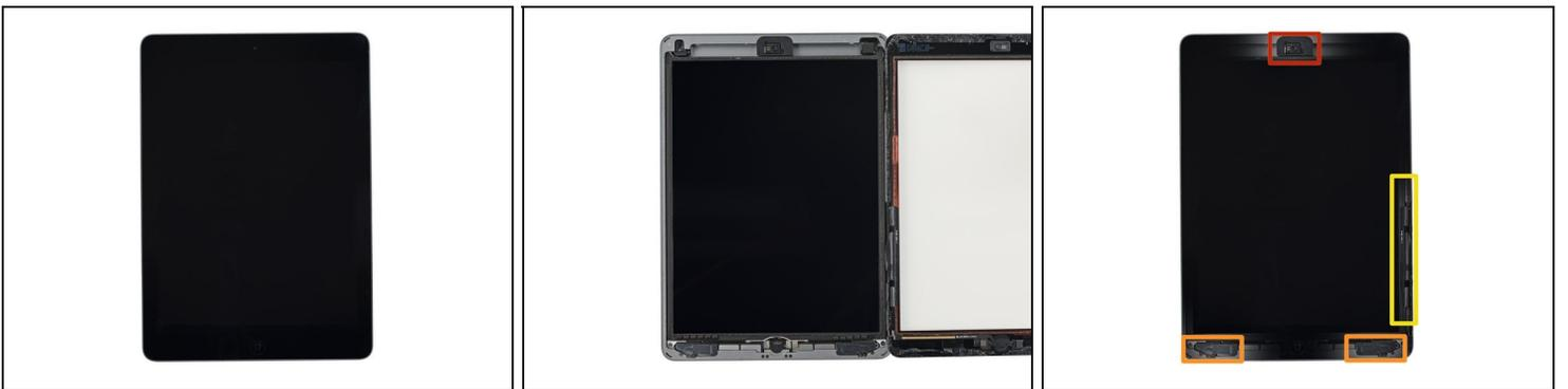
ⓘ Es befinden sich viele empfindliche Komponenten unter dem Glas des iPads. Um Schäden zu vermeiden, erhitze und heble das Glas **nur an den beschriebenen Stellen**.
